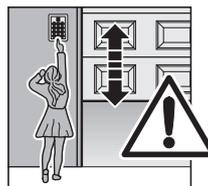
**Warnschilder gegen Einklemmen sind an auffälliger Stelle oder in der Nähe der festinstallierten Taster zum Verfahren des Antriebes dauerhaft anzubringen.**
