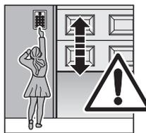
**Waarschuwbordjes tegen het vastklemmen moeten permanent worden aangebracht op een opvallende plaats of in de nabijheid van een vast bedieningselement van de aandrijving.**
