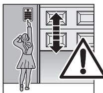
et se ferme correctement. Les appareils de commande fixes (p. ex. boutons-poussoirs) doivent être placés en vue de la porte, mais à distance des pièces mobiles et à une hauteur minimale de 1,5 m. Ils doivent absolument être installés hors de portée des enfants!
