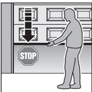
inlichten over de correcte en veilige bediening. De veiligheidsterugloop en de mechanische ontgrendeling demonstreren en testen. Houd de deur tijdens het dichtlopen met beide handen tegen. De aandrijving moet zachtjes uitschakelen en de deur moet terug opengaan. De deuraandrijving moet bij de openingsbeweging zacht uitschakelen en de deur stoppen. De deur alleen bedienen wanneer U zicht heeft op het bewegingsbereik van de deur.
