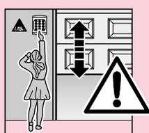
**Les appareils de commande fixes (par exemple boutons-poussoirs) doivent être placés en vue de la porte, mais à distance des pièces mobiles et à une hauteur minimale de 1,5 m. Ils doivent absolument être installés hors de portée des enfants!**
